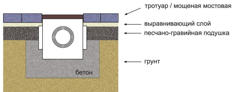
2. Подсоединить дренажную трубу Ø70-130 мм. через соответствующий стыковочный узел, предварительно вырезав в нем отверстие (при необходимости место стыковки обработать герметиком).
