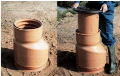
8. В случае возникновения необходимости применения люков колодца диаметром 315 мм. на шахтной трубе диаметром 425 мм., перед их сборкой необходимо в гофрированную трубу установить специальную переходную муфту 425-315 мм..
